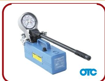
**Tester para inyector Diesel
